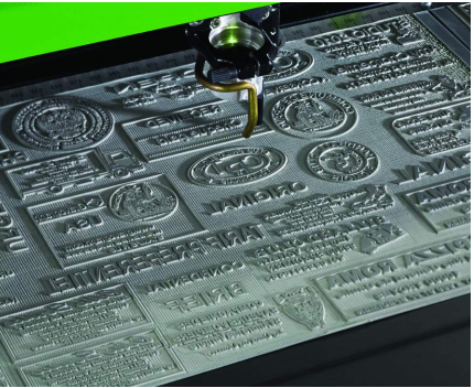
Gravure et découpe laser de tampons caoutchouc
